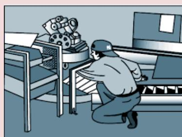
**Зажатие между предметами.** Чтобы движущийся предмет не зажал часть или все тело работника, применяйте защитные ограждения и защитную блокировку оборудования.
